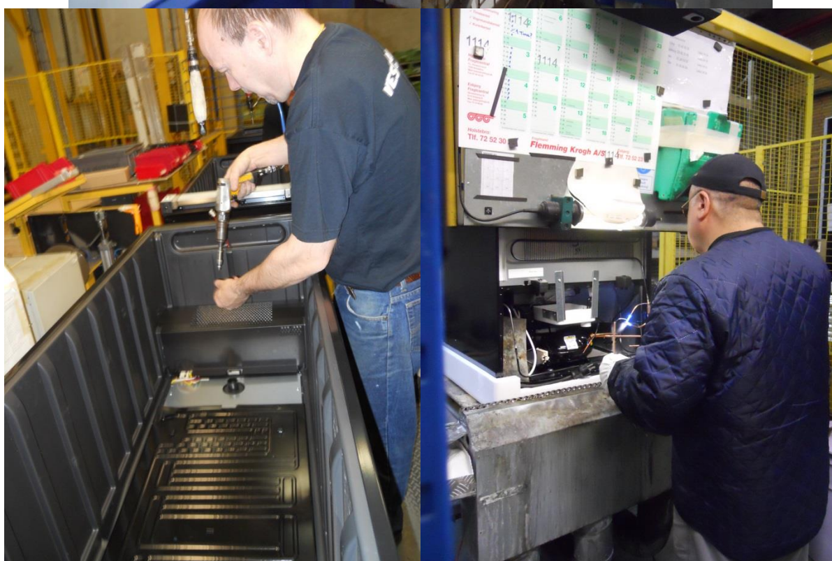
Figur 6-1: Foroven: Produktion af en af de 10 nye vinkølere. Der er mange folk involveret med at følge de 10 kølere langs samlebåndet hos Vestfrost solutions. Her bliver inder- og yderkabinet samlet før opskumning med isolering. Forneden, tv: montage af fordamper i inderkabinet. TH: Lodning af kølerør til studs på kompressor.
