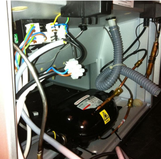
Figur 9-36: Billede af SECOP kompressor monteret i vinkølerens maskinrum. Rigeligt med plads
