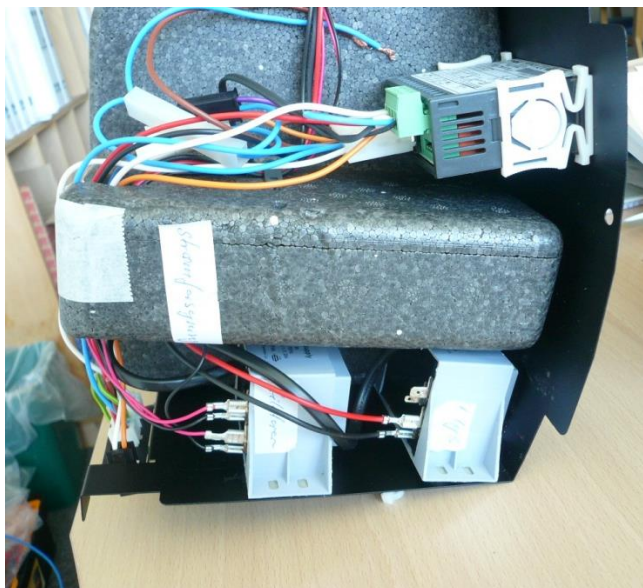
Figur 9-13 Blæserkasse til vinkøler med 2 strømforsyninger og Dixellstyring
