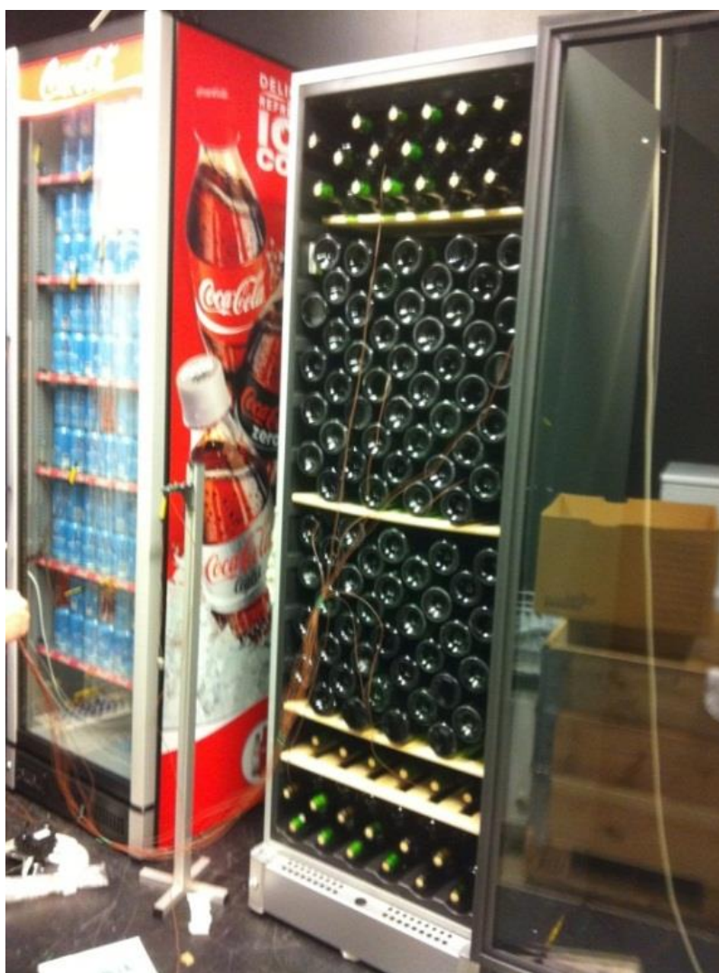
Figur 5-3: I denne test er vinkøleren fyldt med 198 vinflasker med vand for at se, om skabet kan holde temperaturerne under drift (test 5). I denne test er omgivelsestemperaturen 43°C. Vinkøleren kunne holde temperaturen indenfor tolerancerne ( \pm 4K ) med én ventilator. Foto fra klimakammer på Teknologisk Institut
