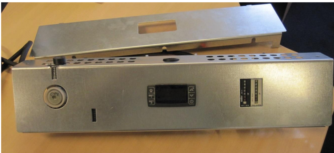
Figur 7-2: Timetællere, Logger til omgivelsestemperaturen og energimåler placeret i fodsparket.
