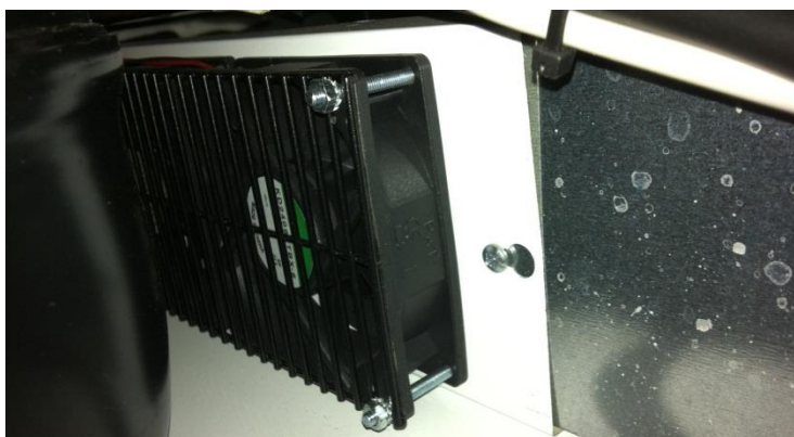
Figur 9-20 "3 på stribe ventilatorer" med placering bag kompressor
