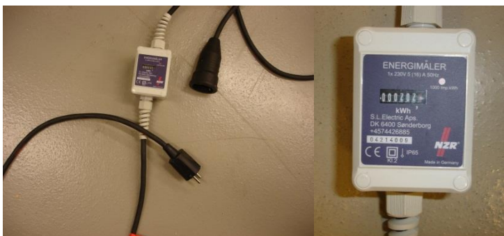
Figur 7-3: Energimåleren benyttet i fieldtesten
