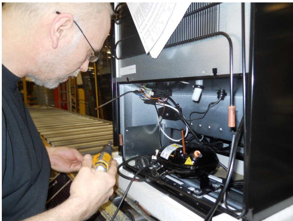
Figur 6-2: Montage af den nye SECOP XV5XK-kompressor i vinkøleskabet. Har ses det tydeligt, hvor lidt den fylder. Der er potentiale til at udnytte en stor del af kompressorummet til at forøge nettovolumen af køleskabet. Kompressoren fik hurtigt kælenavnet ”Skildpadden” af medarbejderne på fabrikken
