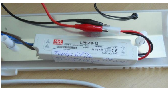
Figur 9-9: Figur 0 3 Mean Well transformer til belysning i flaskekøler
