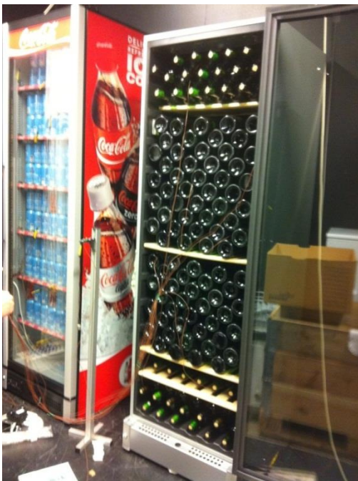
Figur 9-31: Billede af vinkøler pakket med 198 vinflasker indeholdende vand
