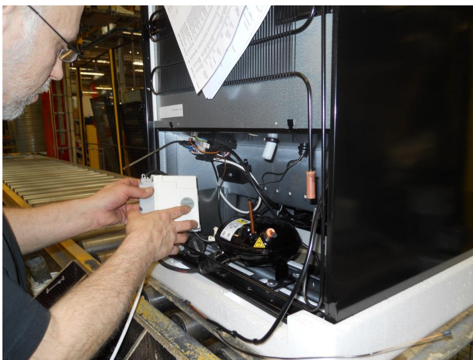
Figur 6-3: montage af den elektroniske styreenhed til kompressoren
