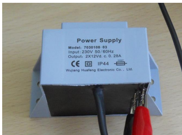
Figur 9-10 Transformer til lys og/eller fordamperventilatorer på vinkøler
