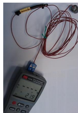
Figur 7-6 : RS 1316 Reference temperatur, elektronisk instrument til måling af temperatur.
