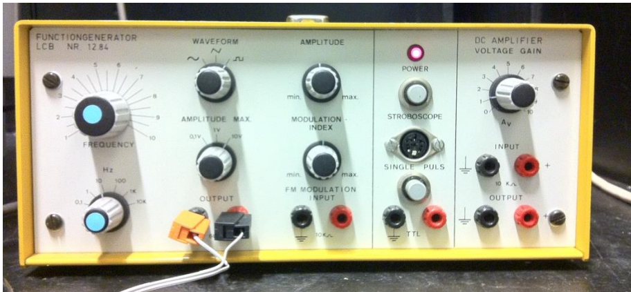
Figur 9-37: Billede af frekvensgenerator til styring omdrejningstal anvendt under test af SECOP kompressor
