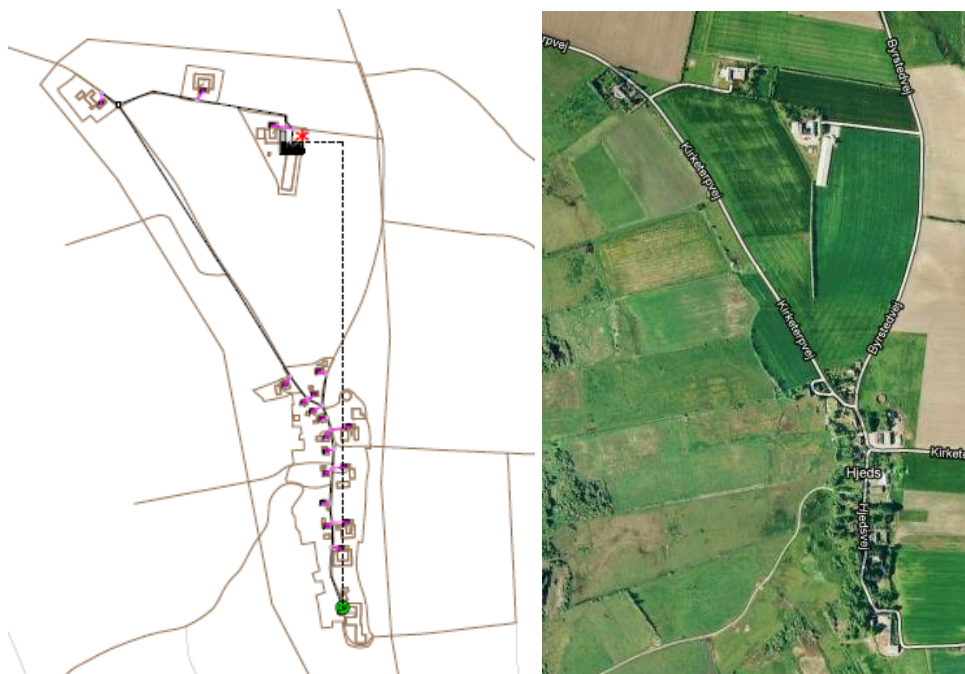
Figur 8. Her er Hjeds angivet med tegningen t.v. hvor der er taget udgangspunkt i en traditionel fjernvarme forsyning fra kyllingefarmer Peder Pedersen på Byrstedvej 9. Den stiplede linje angiver at trykket i fjernvarmrørene styres fra en trykmåler i den yderste ende.
