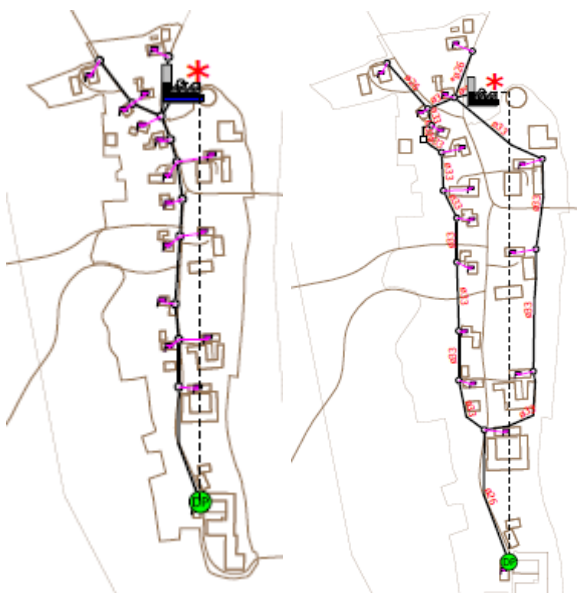
Figur 9. Her er for den lille løsning i Hjeds vist føringen af fjernvarmenettet. Tv. I traditionel design og th. som en ringløsning.
