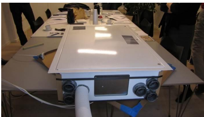
Fig 1.6. 2 Foto af prototype af bygningsintegreret varmegenvinderenhed
