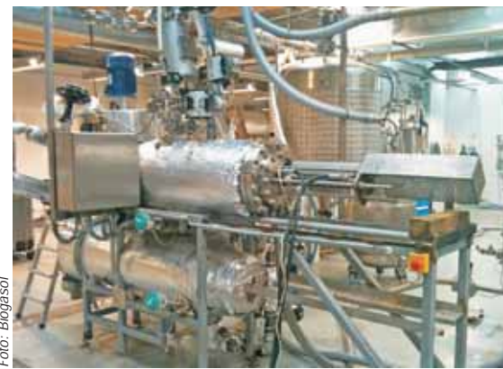
BioGasols pilotanlæg til forbehandling af biomasse.
