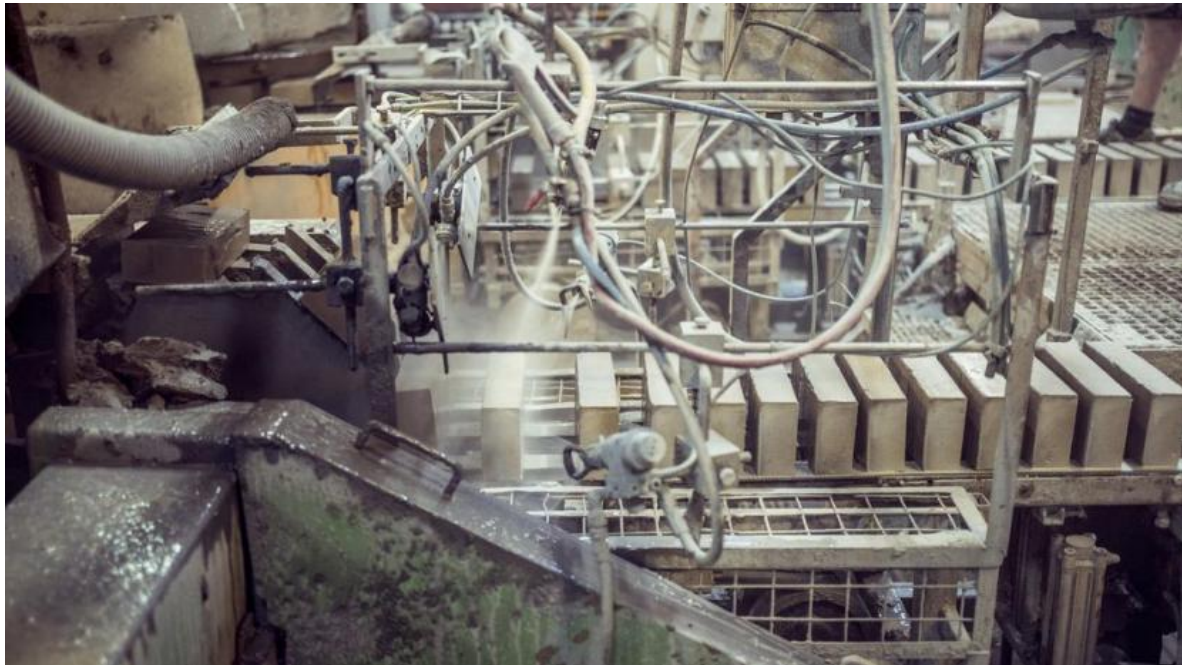
📷 Ødelagte mursten bliver genbrugt i produktionen, der styres af robotter og de 35 ansatte, der arbejder i skiftehold på seks. Foto: Michael Drost-Hansen.
